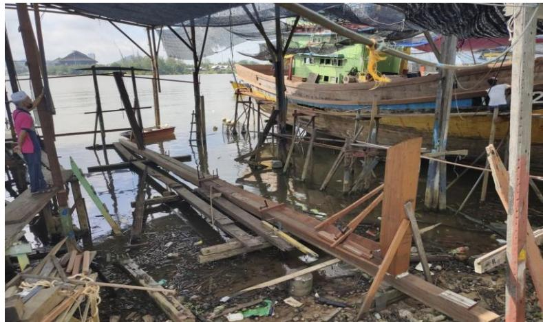
Gambar 3. Sebatang Lunas dan Dua Batang Linggi Diletakkan sebagai Asas dalam Pembinaan Perahu
