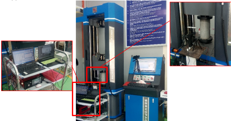
(c) Ujian silinder mampatan mesin UTM disambungkan kepada pencatat data luaran Rajah 3: Persediaan ujian modulus elastik dan nisbah Poisson pada konkrit
