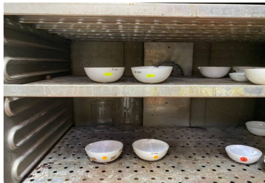
Rajah 2.8 Penapis gentian kaca (GF/A) dikeringkan terlebih dahulu dalam ketuhar yang ditetapkan pada suhu 104°C selama 15 minit
