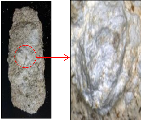
Rajah 12: Tompok putih kapur terhidrat dalam lepaan mortar
