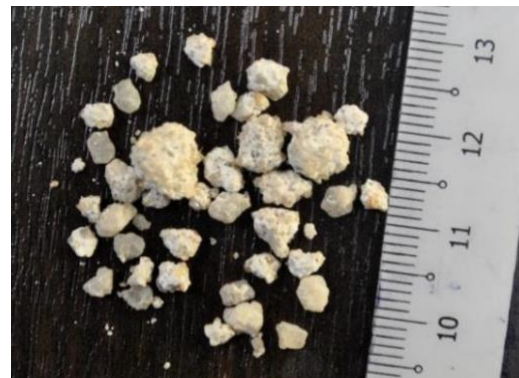
Rajah 15: Konglomerat pasir-pasir halus membentuk pasir besar.
