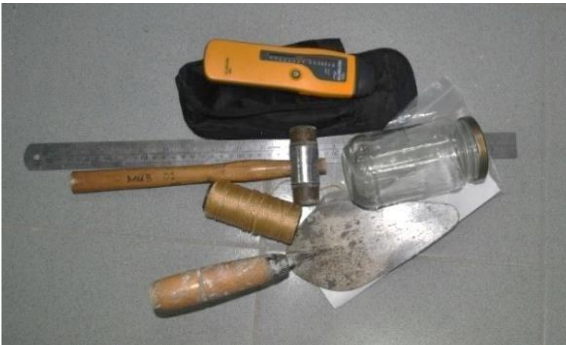
Rajah 7: Sebahagian peralatan yang digunakan semasa pemeriksaan kondisi di tapak
