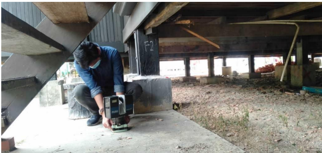
Rajah 10: Pengimbasan 3D TLS di tapak Nilam Puri Sumber: Penulis, 2022
